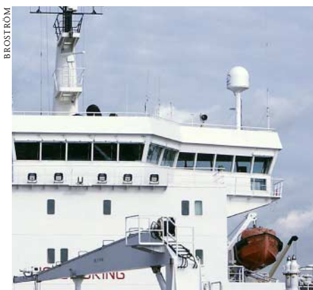
Broströms "Bro Atland" är ett av de fartyg som har installerat V-SAT. Antennen sitter på fartygets babordssida, till höger i bild.
